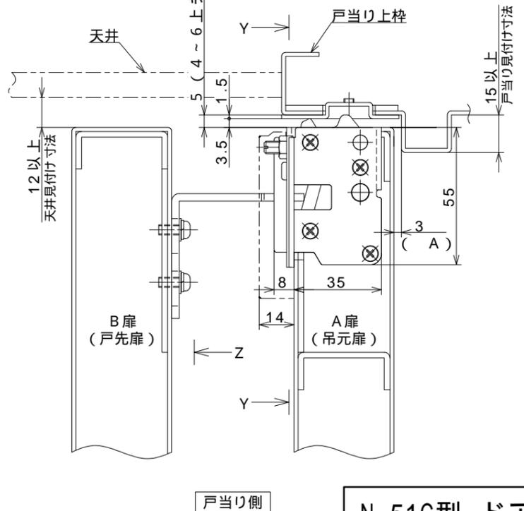
1. 本図は戸当り上枠と扉との上チリを5mm、面落ちを5mm、隙間(A)を3mm、扉厚40mm、扉間40mmを基準として表示します。
